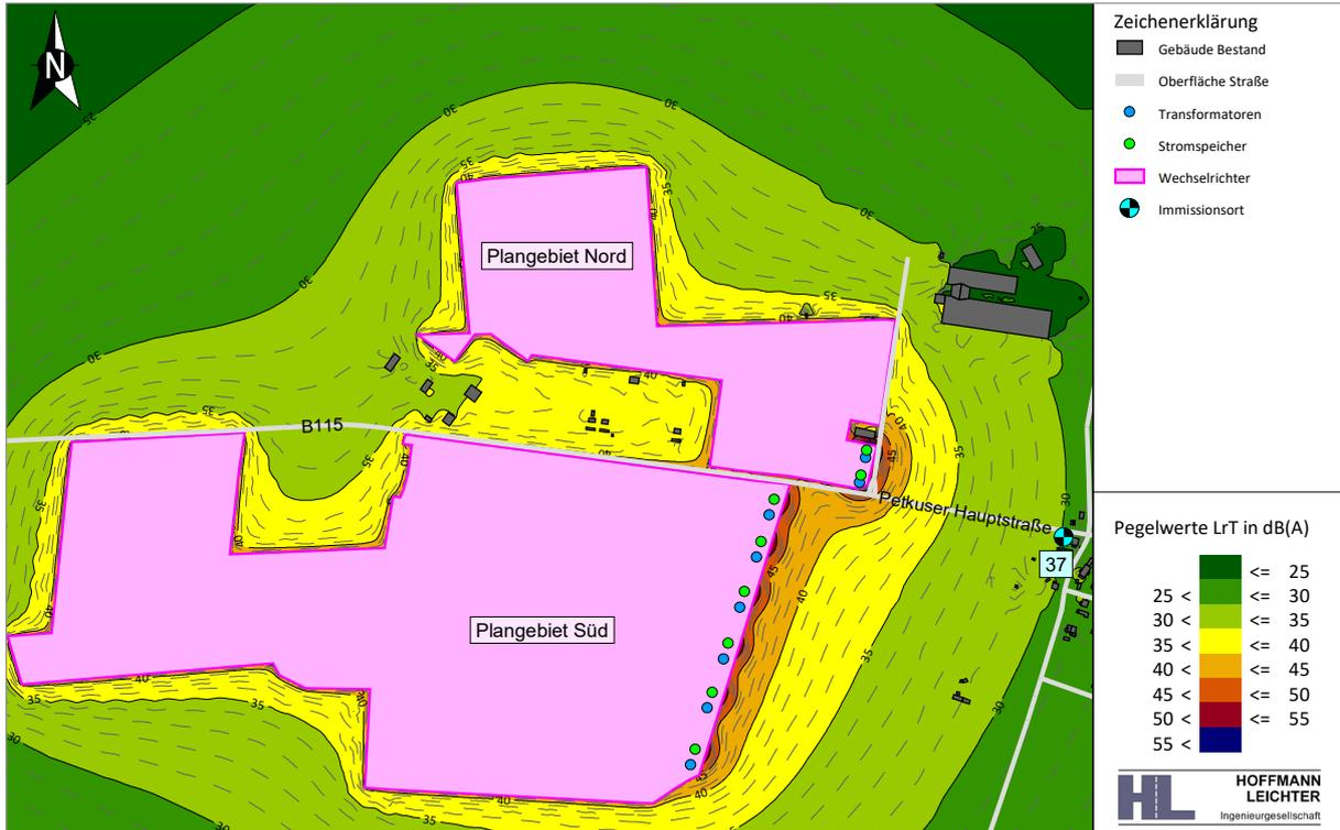
Abbildung 5-1 Isophonenkarte in 2 m Höhe über Gelände | Beurteilung nach TA Lärm | tags, 06:00 - 22:00 Uhr
