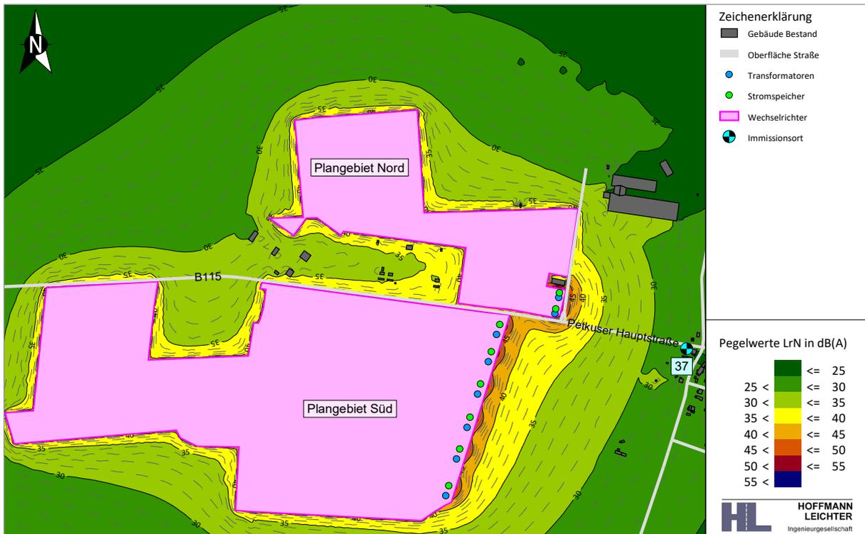
Abbildung 5-2 Isophonenkarte in 2 m Höhe über Gelände | Beurteilung nach TA Lärm | nachts, 22:00 - 06:00 Uhr
