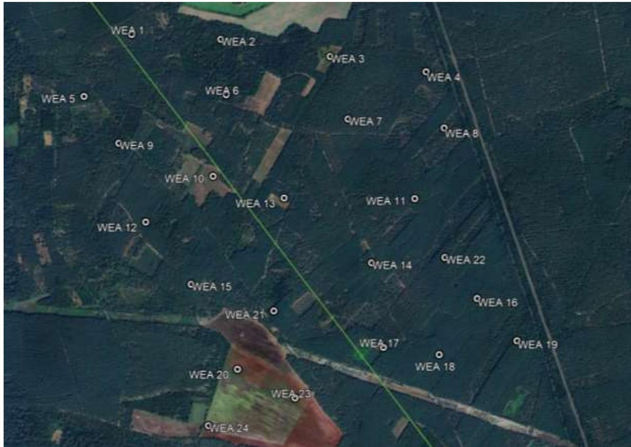
Abbildung 7: Lagedarstellung der Richtfunkstrecke, grün gekennzeichnet, zu den geplanten WEA
