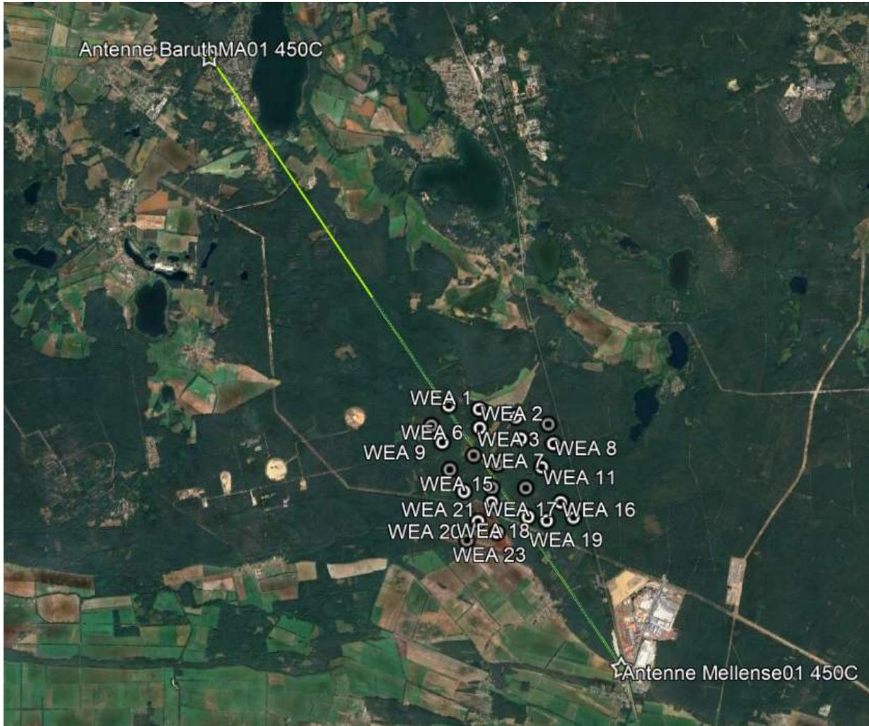
Abbildung 6: Darstellung der Richtfunkstrecke zu den geplanten WEA als Gesamtübersicht
