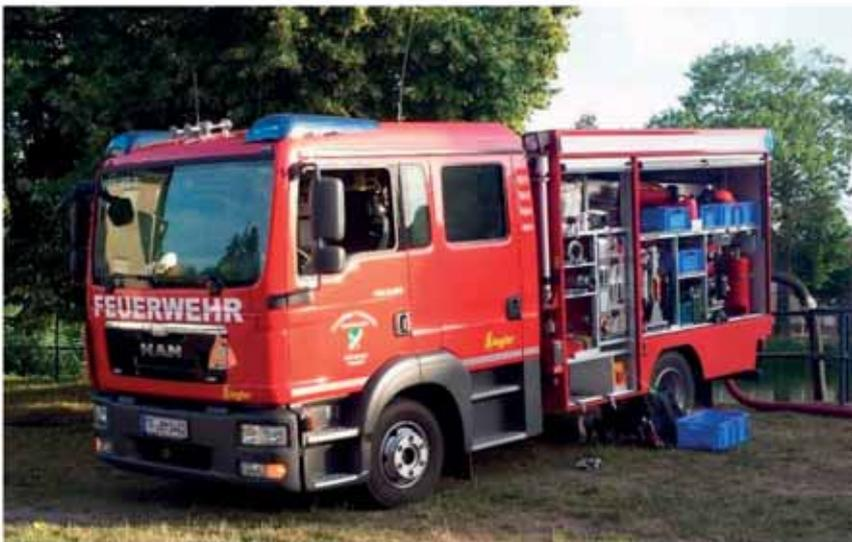
Das Tragkraftspritzenfahrzeug-Wasser (TSF-W) der Ortswehr Merzdorf basiert auf ein MAN-Fahrgestell und ist nicht geländegängig. Es wurde von der Fa. Ziegler in Mühlau aufgebaut und im November 2014 der Ortswehr übergeben. Die Mannschaftskabine bietet Platz für sechs Kameraden (Staffelkabine). Das TSF-W hat ein Gesamtgewicht von 7,5t. Im Aufbau befinden sich 800l Wasser und eine Feuerwehrtechnische Beladung für eine Gruppe. Weiterhin stehen ein 50m Schnellangriffsschlauch,
