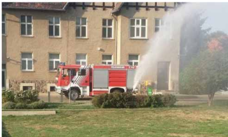
Das TLF 4000 der Ortswehr Baruth/Mark mit angebaute Hydroschild, die Konstruktion kann auch in der Waldbrand Bekämpfung eingesetzt werden
