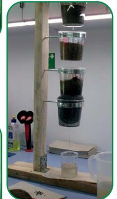
Durch die eigens für uns gebaute Kleinkläranlage, konnten wir im Labor beobachten, wie das Abwasser verschiedene Filterstationen durchläuft und gereinigt wird.
