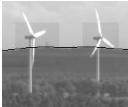
Abbildung 1: Automatisch generierte Ausschlussgebiete um Rotoren von WEA
